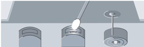
Bei längerem Betrieb bildet der vom Tonband abfallende magnetische Staub eine Schicht auf dem Wiedergabekopf (PLAY), der Tonwelle (PINCH ROLLER) und der Bandandruckrolle (CAPSTAN).
