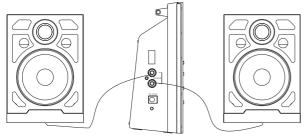
Die linke Lautsprecherbox ist mit der Buchse SPEAKER L 20 und die rechte Box mit der Buchse SPEAKER R 20 zu verbinden.
