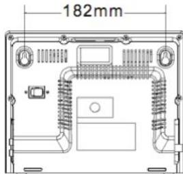
Bohrungsabstand Gerät: 182 mm
