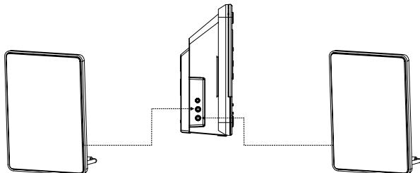
L'altoparlante sinistro deve essere collegato alla presa SPEAKER L 4 e quello destro alla presa SPEAKER R 4. Al fine di ottenere la massima qualità sonora, posizionare, se possibile, gli altoparlanti di modo che essi formino un triangolo equilatero con il punto in cui si è posizionati.
