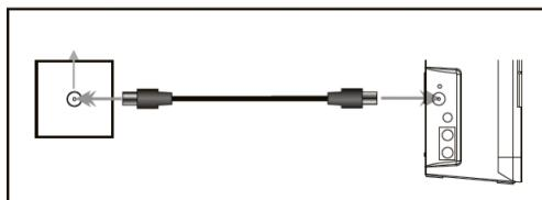
Grazie all'antenna FM è possibile ottenere una ricezione adeguata. Inserire l'antenna a filo nella presa per antenna 2. L'antenna deve essere estratta completamente e orientata al meglio. In caso di ricezione insufficiente si consiglia di posizionare il tasto ST/MO su MONO.
