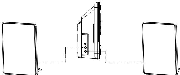
Die linke Lautsprecherbox ist mit der Buchse SPEAKER L 4 und die rechte Box mit der Buchse SPEAKER R 4 zu verbinden. Um die beste Klangqualität zu erhalten, positionieren Sie die Lautsprecher möglichst so, dass diese ein gleichschenkeliges Dreieck bilden.
