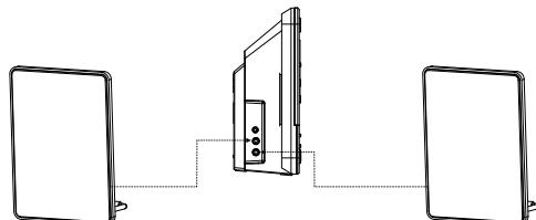
Die linke Lautsprecherbox ist mit der Buchse SPEAKER L 4 und die rechte Box mit der Buchse SPEAKER R 4 zu
