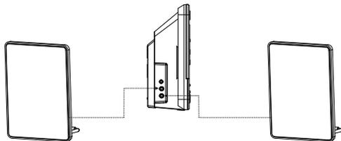
Die linke Lautsprecherbox ist mit der Buchse SPEAKER L 4 und die rechte Box mit der Buchse SPEAKER R 4 zu verbinden.
