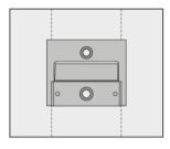
→ Führen Sie die Halteleiste an der Rückseite des Geräts über die Halter und hängen Sie das Gerät so auf.
