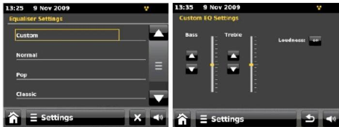
Con l'equalizzatore è possibile adattare la riproduzione in funzione del genere di musica che si sta ascoltando.
