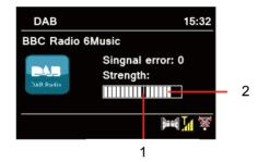
→ Mehrfaches Drücken der INFO-Taste 6 schaltet durch verschiedene Informationen, wie z.B. Programmtyp, Multiplexname, Frequenz, Signalfehlerrate, Datenbitrate, Programmformat, siehe S. 46.
