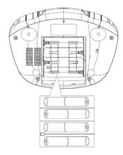
→ Schließen Sie den Batteriefachdeckel wieder sorgfältig, so dass die Haltelaschen des Deckels im Gehäuse einrasten.
