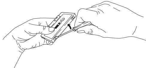
Ces languettes sont déjà ôtées sur les cassettes enregistrés du commerce. Un effacement ultérieur est malgré tout possible, en collant un ruban adhésif sur l'ouverture des languettes avant d'effectuer un nouvel enregistrement.
