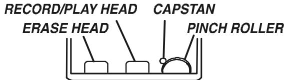
Bei längerem Betrieb bildet der vom Tonband abfallende magnetische Staub eine Schicht auf dem Aufnahme-/Wiedergabekopf (RECORD/PLAY), dem Löschkopf (ERASE), der Tonwelle (PINCH ROLLER) und der Bandandruckrolle (CAPSTAN). Bei Nachlassen der Aufnahme- oder Wiedergabequalität müssen diese Teile mit Alkohol oder Tonkopfreiniger gesäubert werden.
