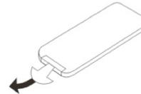
Qualora il telecomando non reagisse ai comandi, sostituire la pila a bottone. Procedere come di seguito descritto.
