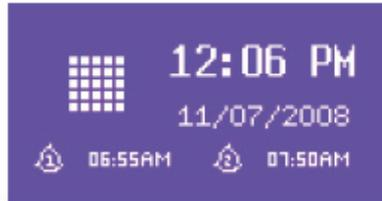
Die Uhrzeit wird über WLAN (Internet) bzw. DAB automatisch eingestellt.
