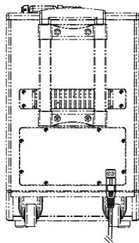
Quando si collega **per la prima volta** l'apparecchio alla rete elettrica, l'accumulatore interno necessita di almeno 24 ore per il processo completo di carica! Ciò è importante per una durata ottimale dell'accumulatore.
