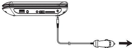
Ziehen Sie den Kfz-Adapter ab und schalten Sie das Gerät aus, bevor Sie die anderen Kabel anschließen.
