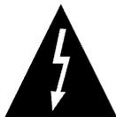
Mit dem Blitzsymbol in dem Dreieck soll der Benutzer vor gefährlicher Hochspannung im Inneren des Gerätes gewarnt werden. Es besteht die Gefahr eines elektrischen Schlages!
