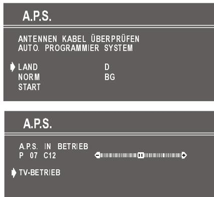
Wenn Sie die APS-Funktion vor dem Start stornieren möchten, betätigen Sie die Taste "TV". Wählen Sie zu allererst das "LAND" aus. Damit wird der Sortierprozess der APS-Funktion wirksam. Zum Starten der Funktion bewegen Sie den Cursor mit der Taste "P+" or "V-" auf die Option "START", und drücken Sie die Taste "<" or ">". Wenn Sie den APS-Vorgang mittendrin abbrechen möchten, betätigen Sie die Taste "<" or ">".
