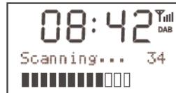
Nach Beendigung des Sendersuchlaufs wird die erste Station in alphanumerischer Reihenfolge wiedergegeben.
