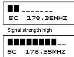
L'affichage de la force du signal vous aide à orienter correctement l'antenne ou à trouver l'emplacement optimal pour votre radio DAB.
